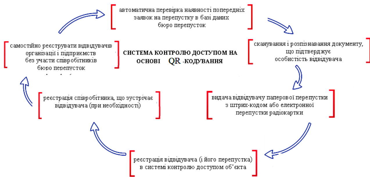
Рисунок 1.10. Алгоритм роботи системи контролю доступом на основі QR-кодування
