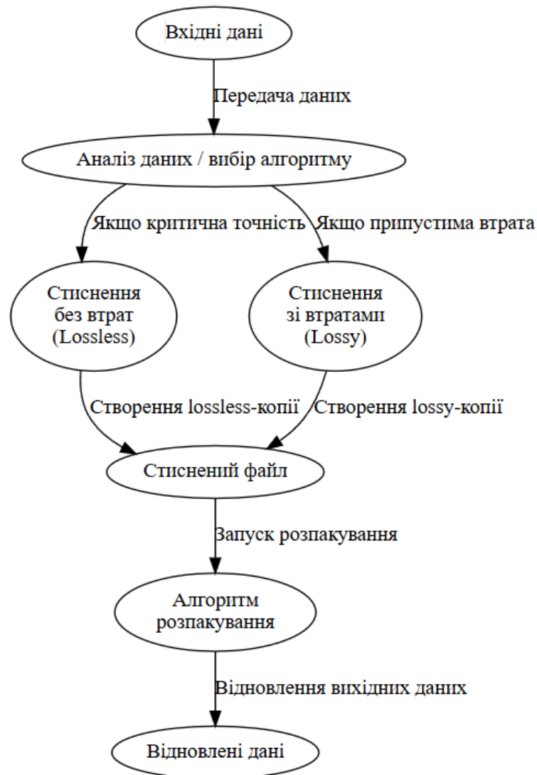
Рисунок 1.4. Схема процесу стиснення та відновлення даних
