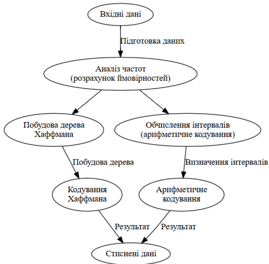
Рисунок 1.6. Схема ентропійного кодування
