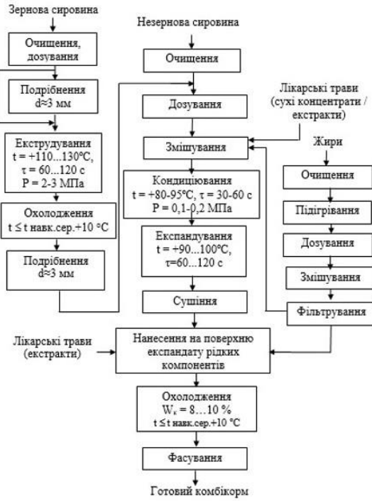
Рис. 12– Поетапна схема технологічного процесу виробництва сухих комбікормів для домашніх тварин
