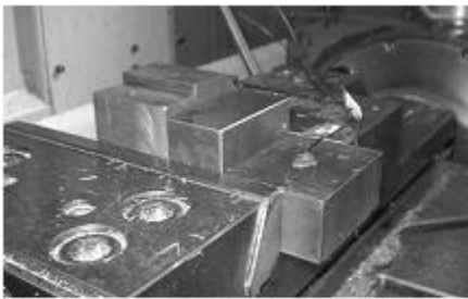
Рис. 1 Расположение вибродатчиков AP 2019 (по осям z и x ) на призматическом образце (слева) и настройка на выполнение рабочего хода фрезерования (справа) на станке мод. 500 V/5.
