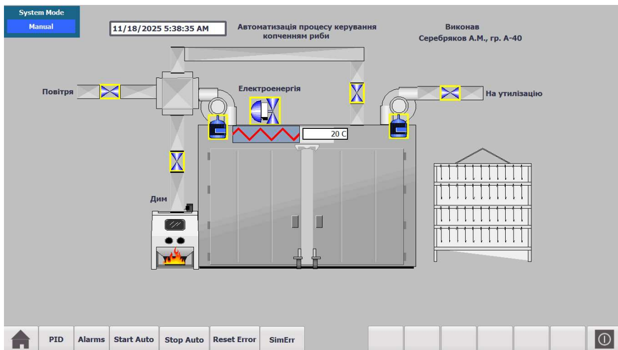
Рис. 7.16 Схема установки в ручному режимі
