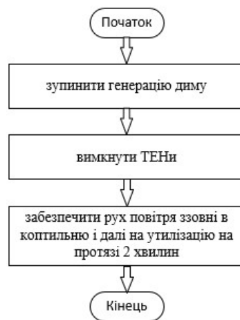
Рис. 4.3 Алгоритм функціонування при зупинці копильні
