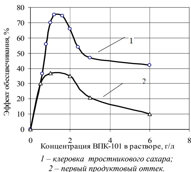
Рис. 1 – Зависимость эффекта удаления красящих веществ из клеровки тростникового сахара и первого продуктового оттока от количества добавляемого полиэлектролита
