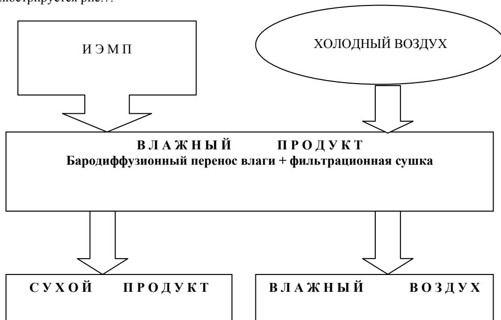
Рис.7 – Схема комбинированных процессов сушки
