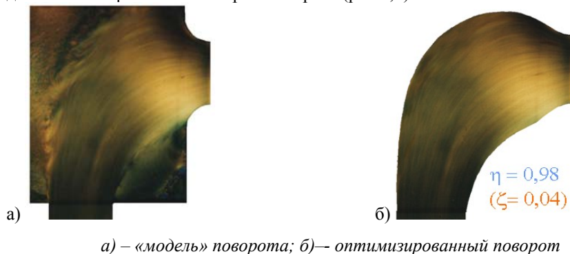
Рис. 3 - Разработка оптимизированного поворота потока на 90°.
