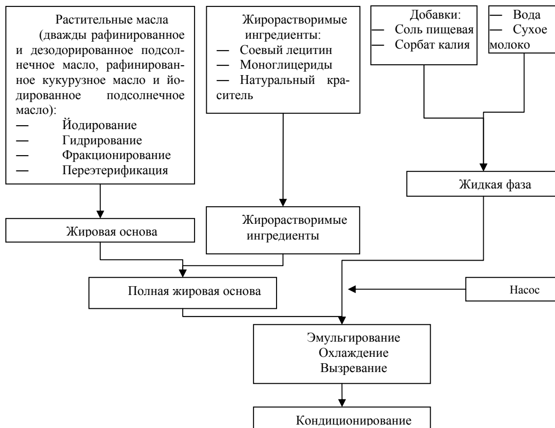
Рис. 3 – Принцип производства йодированного маргарина
