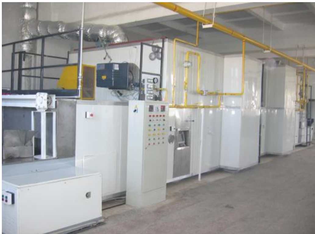
Рис. 1 – Туннельная хлебопекарная печь марки А2-ХПК
