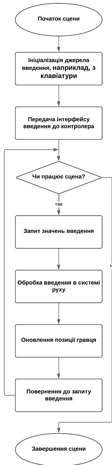
Рисунок 1.9. Функціональна схема роботи логіки керування персонажем
