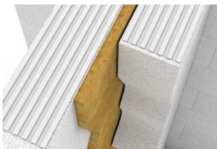
Рис. 1.4 Конструкція масивних, несучих перегородок стін будинку
