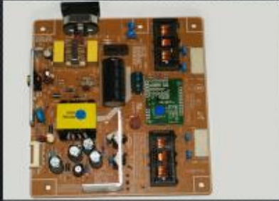
Приклад внутрішнього БЖ
