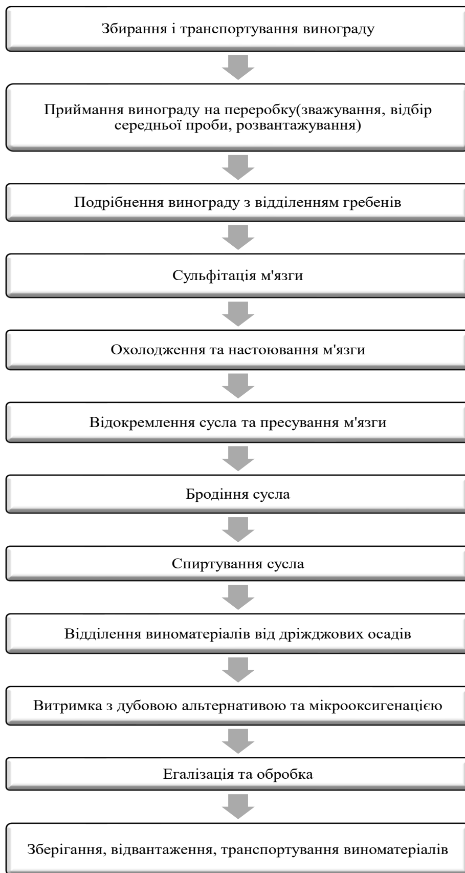
Рисунок 3.3 Принципова схема виробництва виноматеріалів для білих десертних вин.
