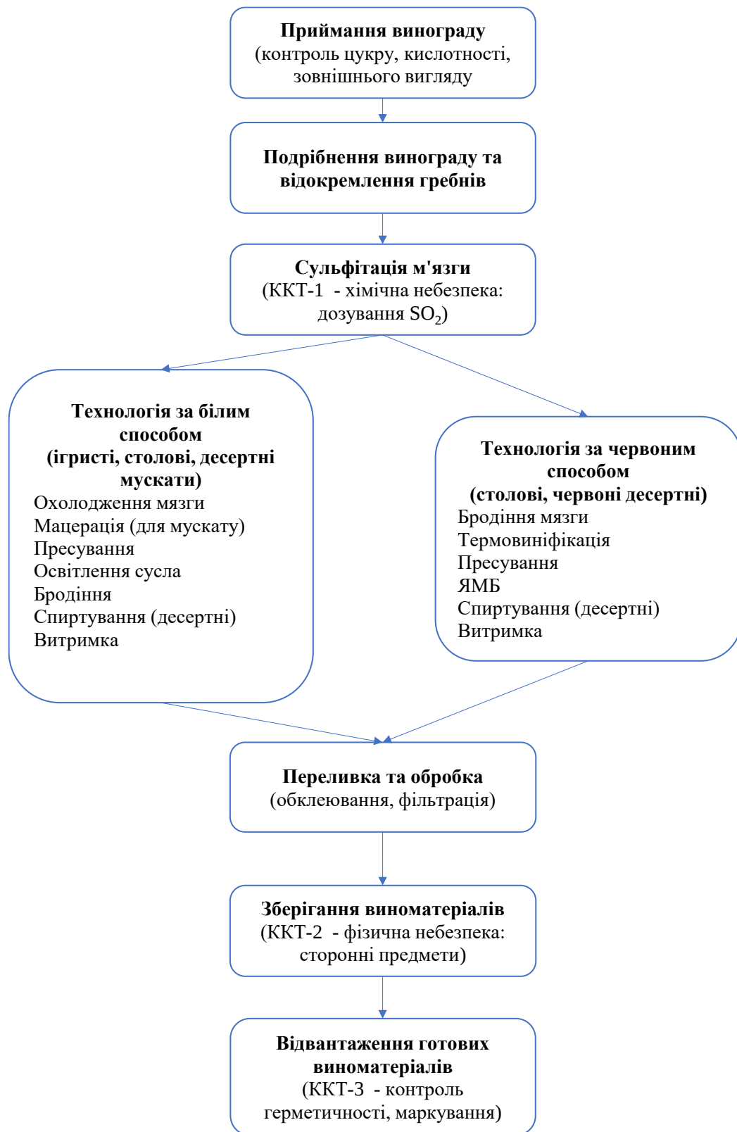
Рисунок 4.1 Блок-схема технологічного процесу виробництва виноматеріалів із визначенням критичних контрольних точок (ККТ).
