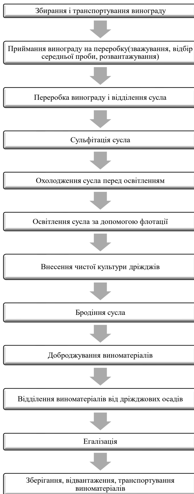
Рисунок 3.1 Технологічна схема виробництва ігристих виноматеріалів
