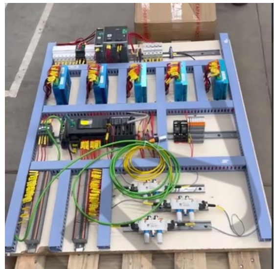
Рисунок. 2 – Фото тестового щита.
