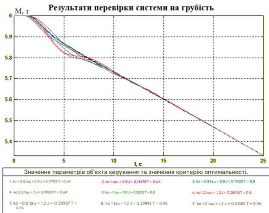
Рис. 3.51 – Вікно результатів перевірки на грубість САР з нейрорегулятором
