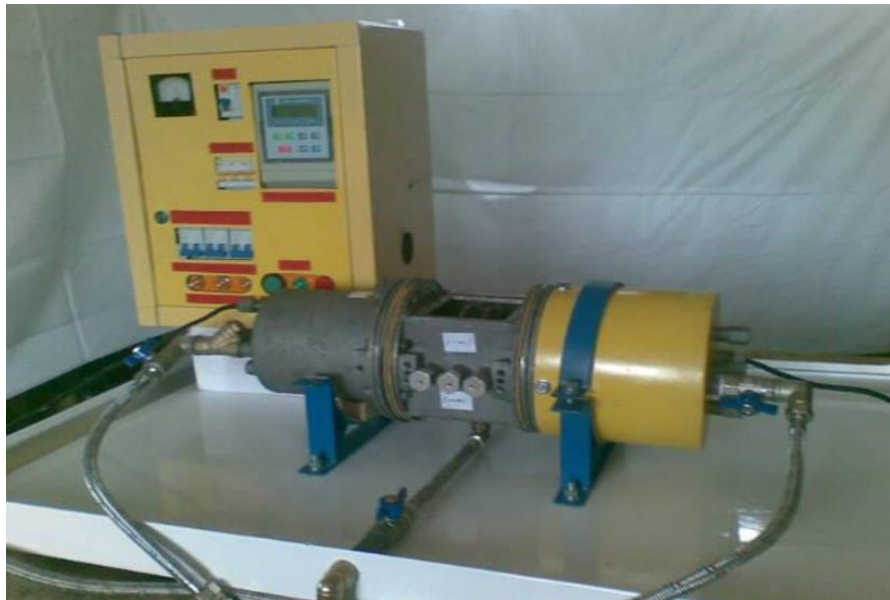
Рис. 2.3. Зображення електромагнітного кавітатора, призначеного для кавітаційної обробки стічних вод з високим рівнем МЧ та ХСК під тиском та при підвищених температурах (з частково знятим захисним кожухом).
