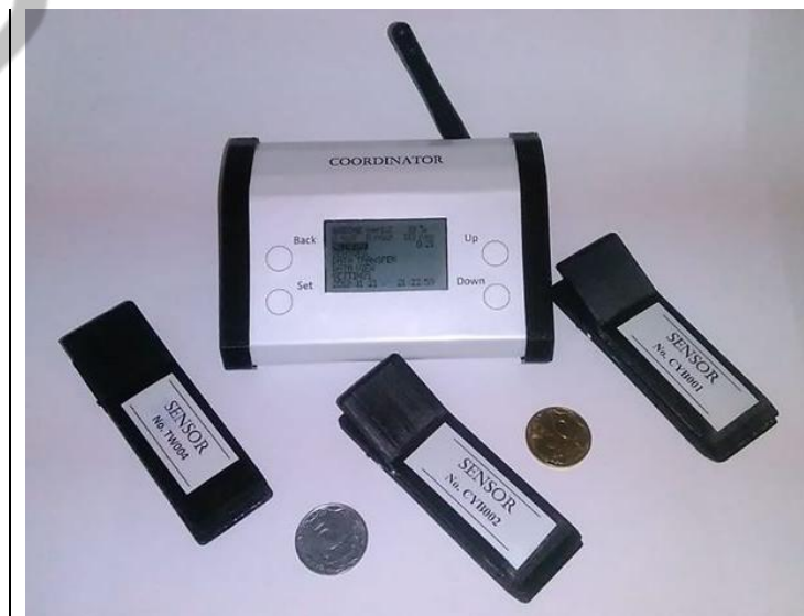
Рис. 3. Дослідний взірець бездротової сенсорної мережі
