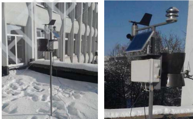
Рис. 4. Фотографії діючого зразка система віддаленого метеорологічного спостереження для передачі і обробки даних в реальному часі
