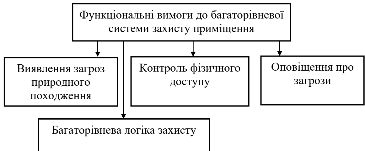
Рисунок 1.8. Функціональні вимоги до багаторівневої системи захисту приміщення
