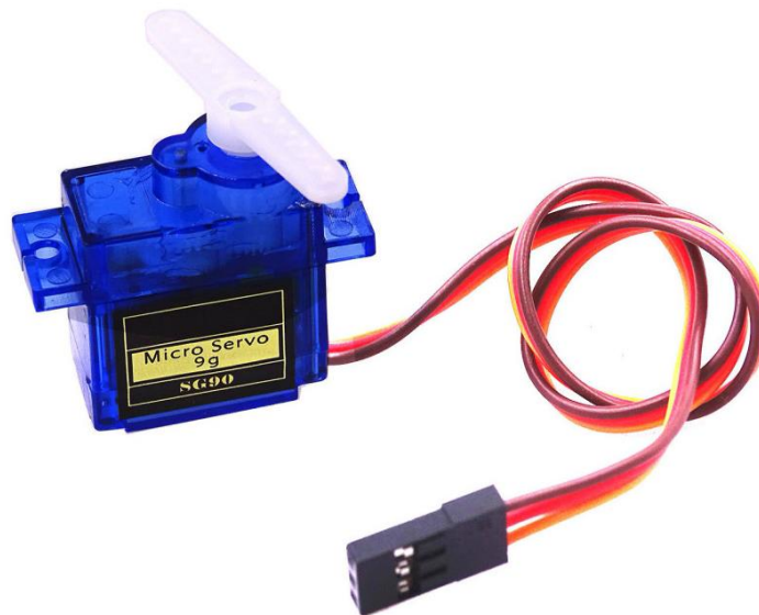
Рисунок 1.13. Зовнішній вигляд сервоприводу SG90
