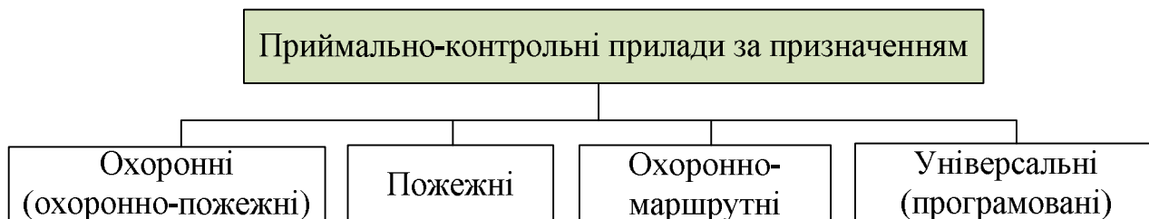
Рисунок 2.5 – Класифікація приймально-контрольних приладів
