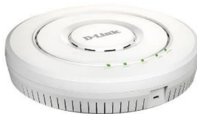
Рисунок 1.12 – Точка доступу D-Link DWL-X8630AP, що підтримує стандартний Wi-Fi 6 (802.11ax)
