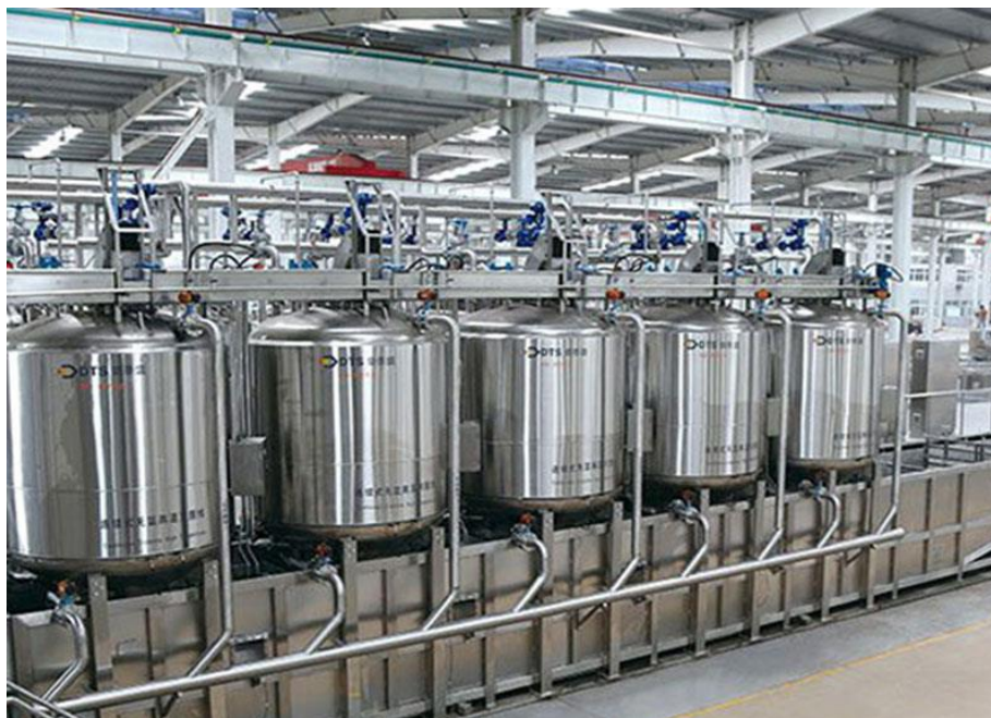
Рис. 1.7.3. – Система автоклавів DTS безперервної дії
