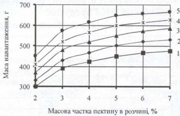
Рис. 7. Зміна міцності гранул від масової частки пектину і хлориду кальцію в розчині: 1 – 1 %-вий CaCl 2 ; 2 – 2 %-вий CaCl 2 ; 3 – 3 %-вий CaCl 2 ; 4 – 4 %-вий CaCl 2 ; 5 – 5 %-вий CaCl 2 .
