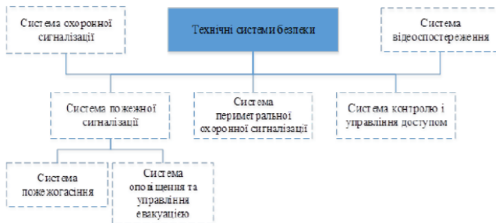
Базовий склад технічних засобів охорони
