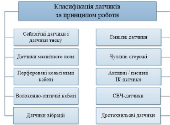
Класифікація датчиків СОП за принципом роботи
