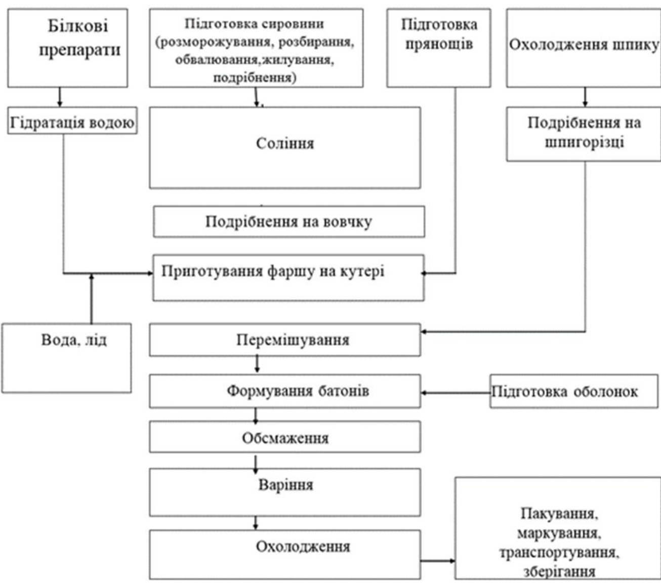
Принципова технологічна схема варених ковбас
