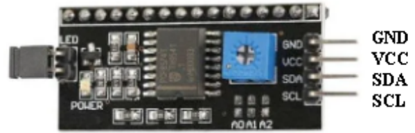
Рисунок 1.11 Зовнішній вигляд послідовного інтерфейсу I2C та його контакти
