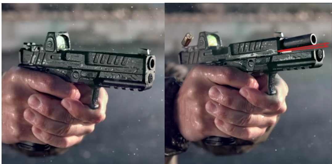
Рис. 2.7 – Особливості руху ствола при відведенні затвору назад
