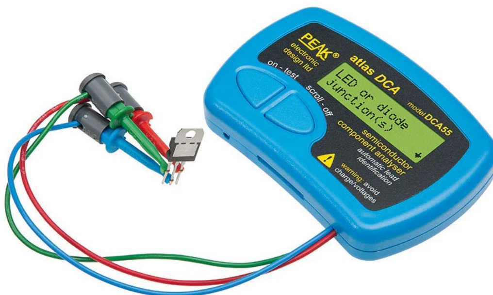
Рисунок 1.4. Тестер транзисторів Peak Atlas DCA55
