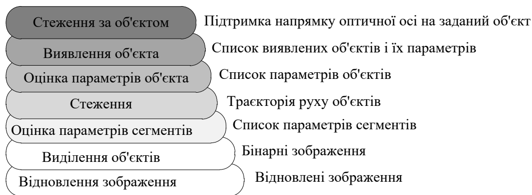
Рисунок 1.13. Ієрархія рівнів обробки відеопотоку для детектора стеження
