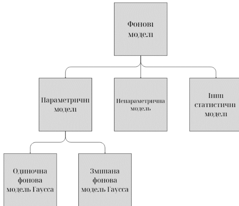
Рисунок 1.11. Моделювання заднього плану
