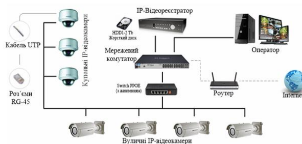
Структурна схема IP-відеоспостереження
