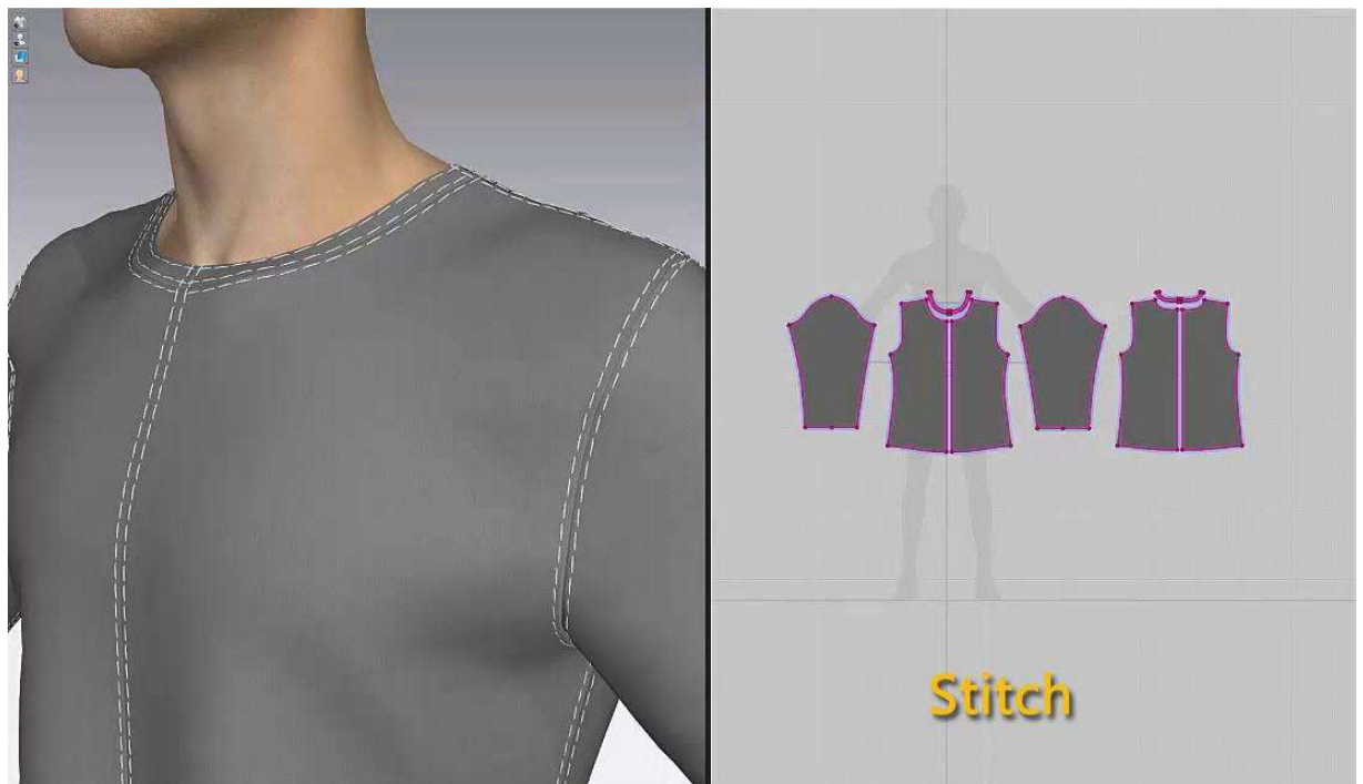
Рис. 2.30 – Приклад використання функції Segment Topstitch
