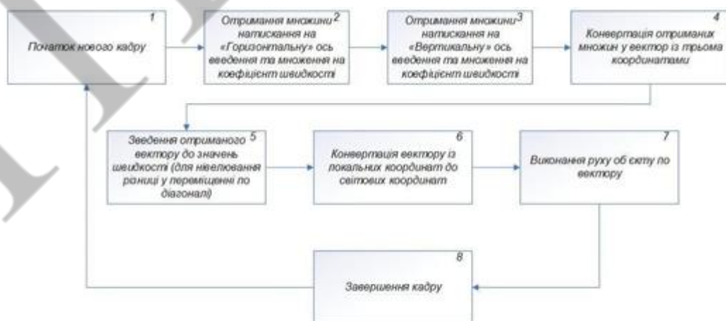
Рисунок 4. Схема роботи коду переміщення об'єкту гравця
