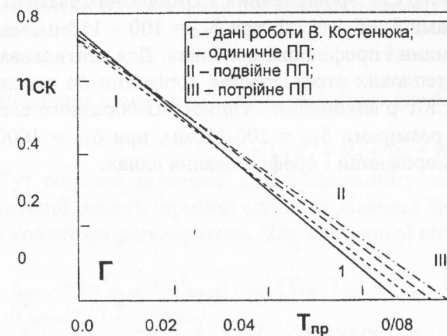
Рис. 2. Полімерні рідинні сонячні колектори СК/П на основі моноблокових багатоканальних полімерних структур (структура СК/р (А і Б) і дані експериментальних досліджень (В). I, II, III – СК/П у складі абсорбера (теплоприймача), теплоізоляції і прозорого покриття (одиночного, подвійного і потрійного, відповідно) у єдиному моноблоці (Г)
