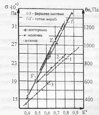
Рис. 8. Зміна граничного напруження зрушення ( \theta_0 ) для фаршу і граничного напруження зрізу ( \sigma ) для готових ковбасних виробів у залежності від комплексної хімічної характеристики фаршу ( K'_\phi ) і готової продукції ( K'_\kappa ): 1 – докторська, 2 – молочна, 3 – свина.
