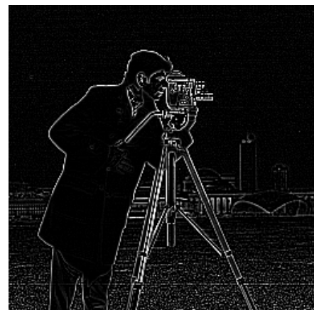
Рисунок 1.11 – Приклад, з наперед зазначеному фільтру лапласіана-гауссіана
