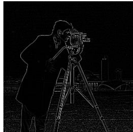
Рисунок 1.10 – Приклад з використанням наперед зазначеного високочастотного фільтру Лапласа
