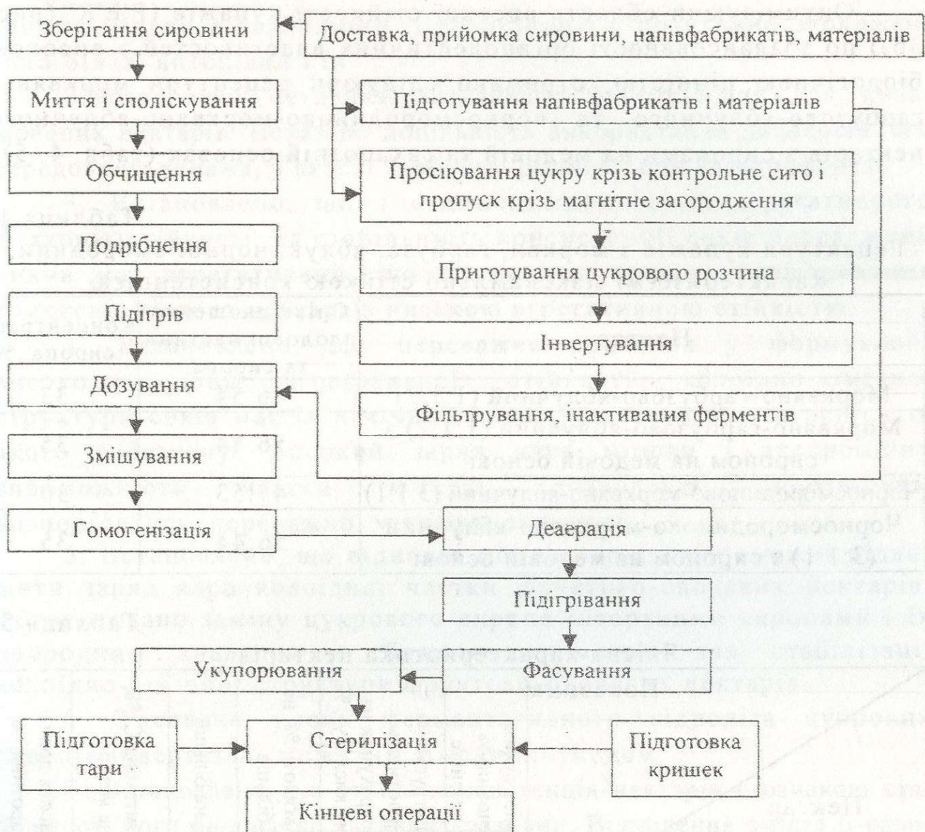
Рис. 8 Технологічна схема виробництва фруктово-овочевих нектарів стабільної консистенції
