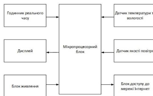
Структурна схема системи контролю мікроклімату в транспортному засобі
