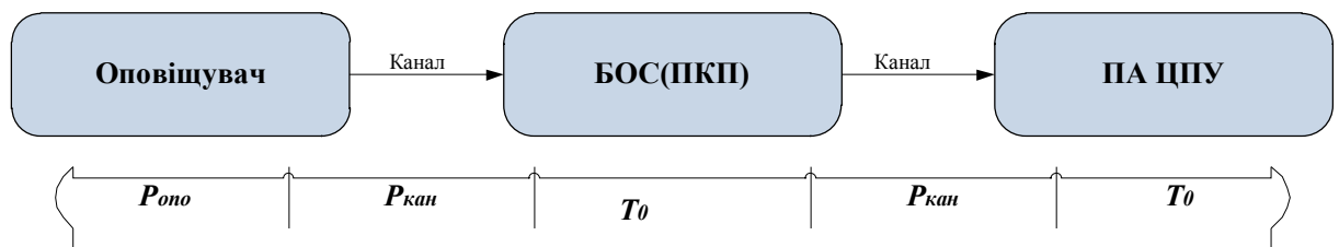
Рисунок 2.8 – Схема роботи охоронної системи
