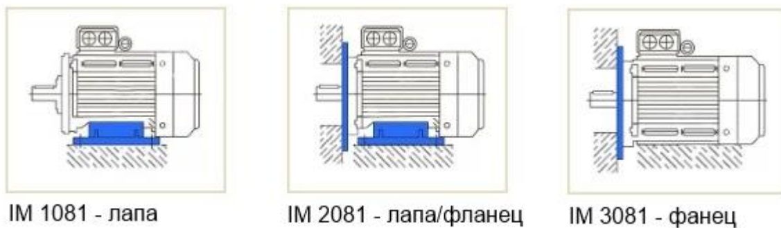
Рис.4.2. Монтажне виконання двигуна АІР 132 М4
