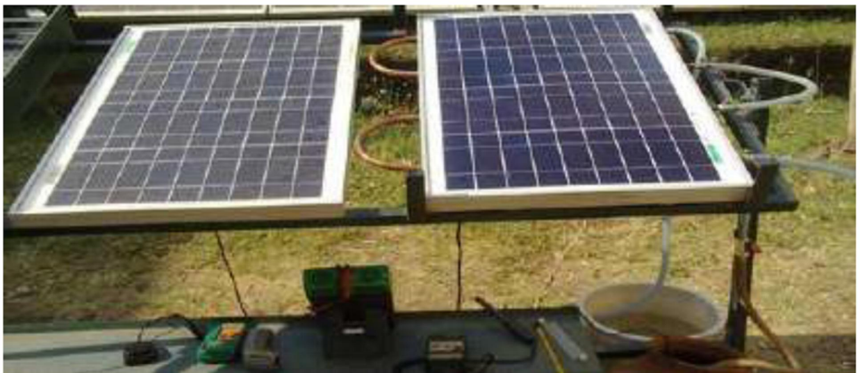
Рисунок 3.13. Експериментальна система з ФЕТ та ФЕ (ліворуч) модулями
