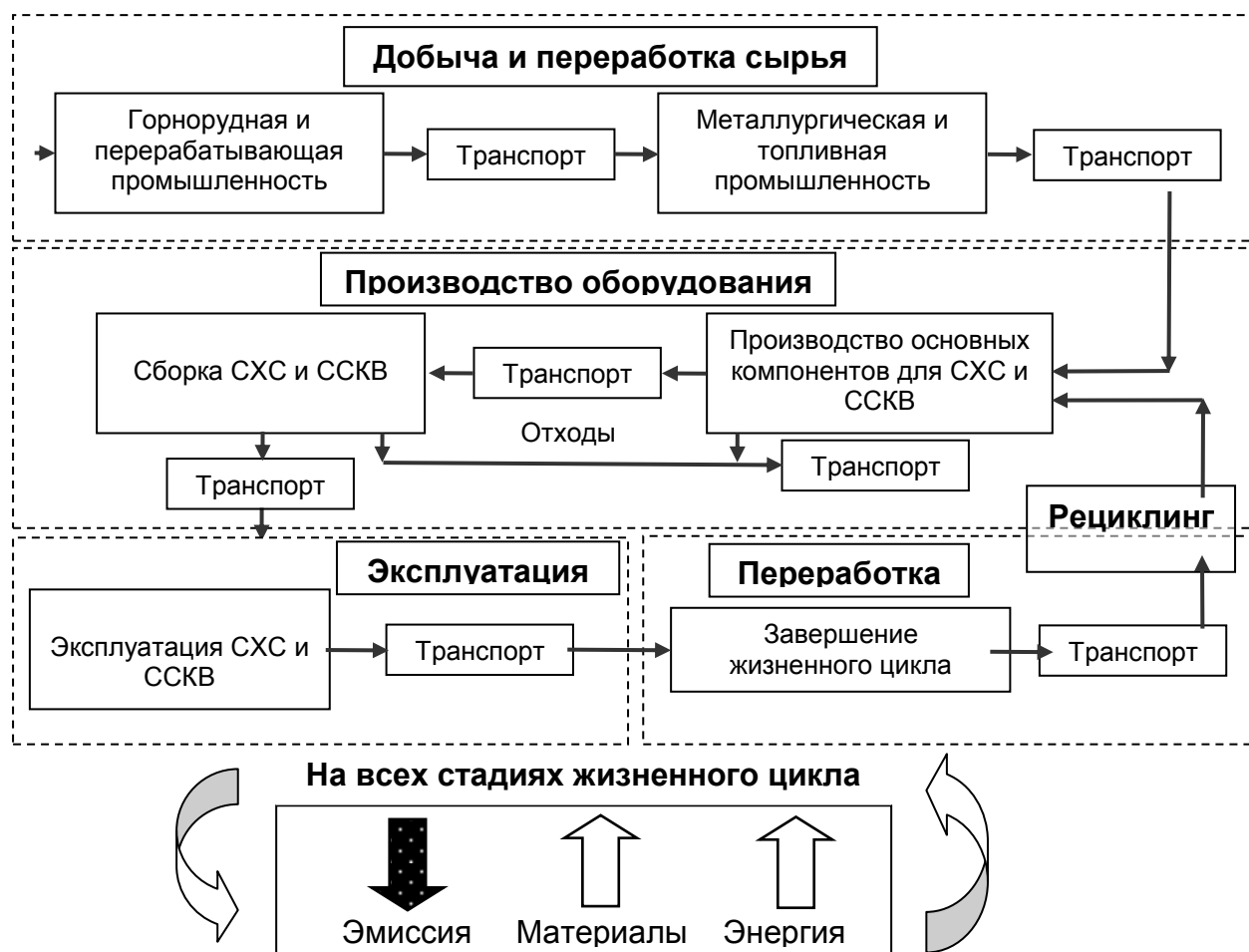
Рисунок 5.29. Упрощенная блок-схема определения системных границ для методологии LCA «Полный жизненный цикл» («ECO-INDICATOR 95»), применительно к задачам СХС и ССКВ.
