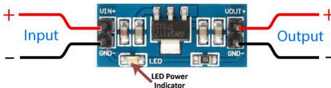
Рисунок 1.20. Стабілізатор напруги AMS1117-5.0
