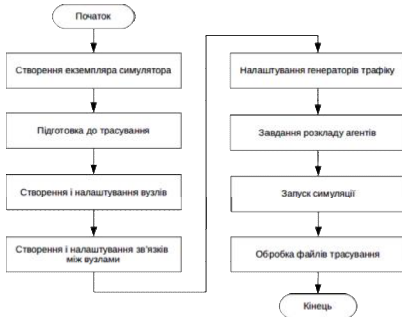
Рис. 1. Загальний алгоритм сценарію моделювання ІНЦПУ в системі NS-2.
