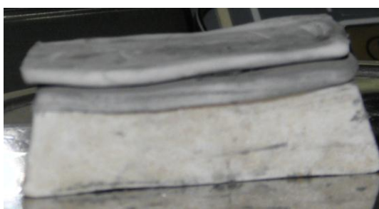
Рис. 3.28 – Образцы для исследования нагрева пластика с порошком железа в микроволновом поле.
