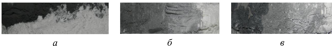
Рис. 3.25. Нагрев порошок железа + оксид алюминия с градиентной структурой
