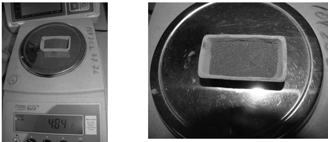
Рис. 3.13. Порошок SiC фракция F240, подготовленный к эксперименту
