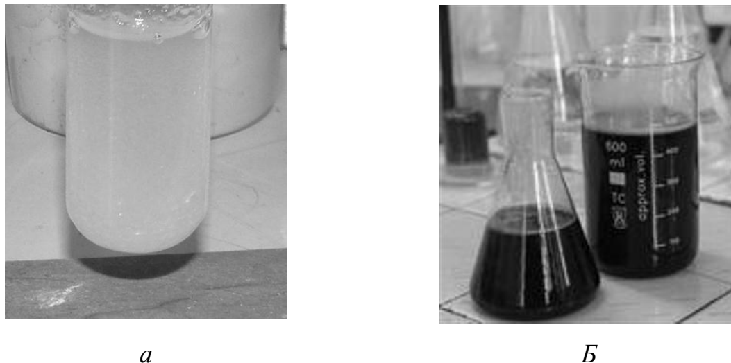
Рис. 3.2. Связующие для экспериментального исследования нагрева порошков как основы получения технической керамики а – поливиниловый спирт, б – лигносульфонат технический.
