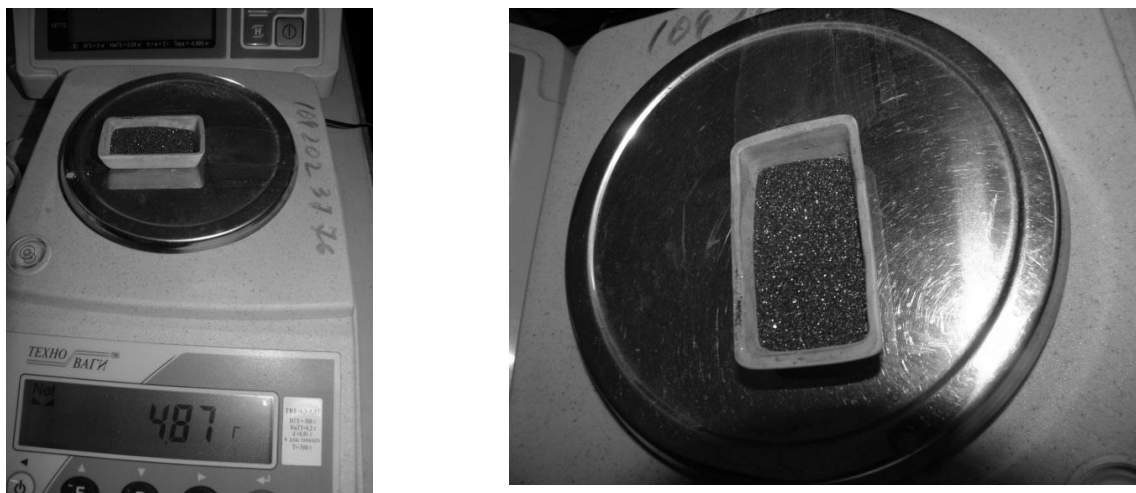
Рис. 3.11. Порошок SiC фракция F100, подготовленный к эксперименту
