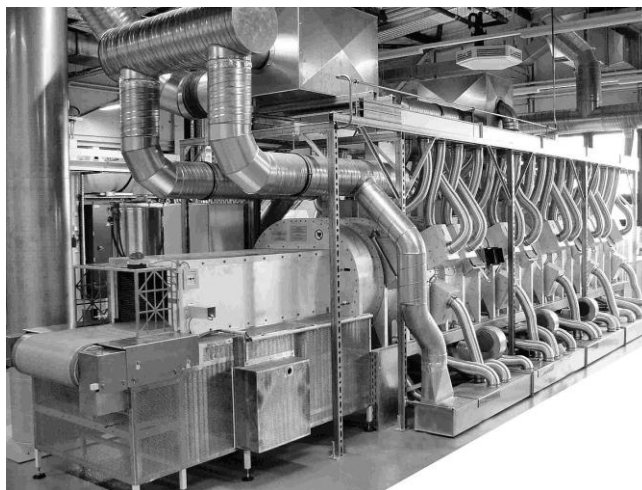
Рис. 1.7. Промышленная гибридная микроволновая печь с внешним электрическим обогревом ( Linn High Therm GmbH, Germany)
