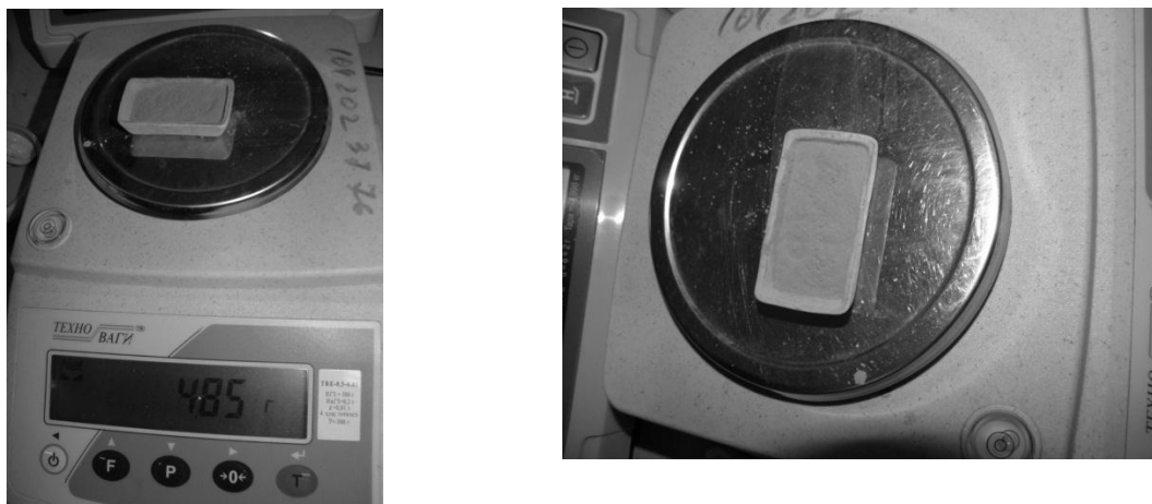
Рис. 3.15 .Порошок SiC фракция F600, подготовленный к эксперименту
