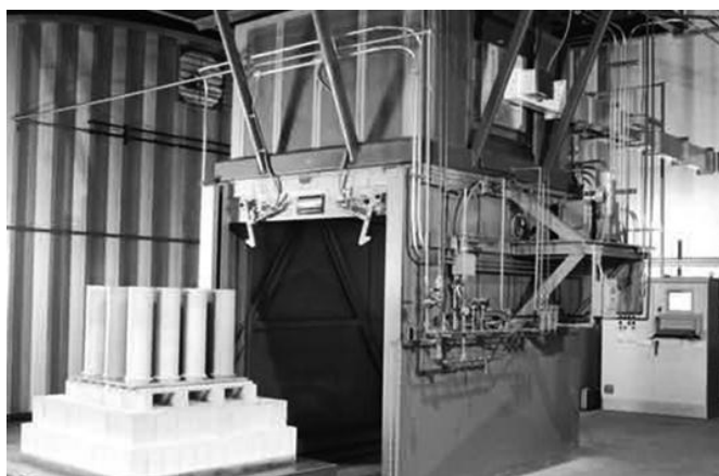
Рис. 1.6. Промышленная гибридная микроволновая камера для спекания керамики (Harrop Industries, USA). Внешний источник – продукты сгорания газа
