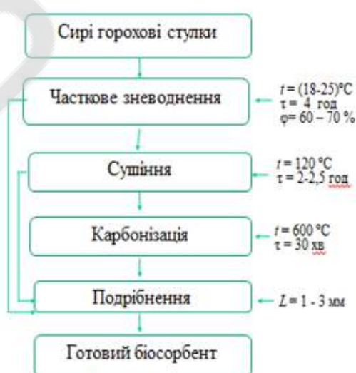
Рис. 1 – Технологічна схема підготовки сировини для виробництва біосорбенту
