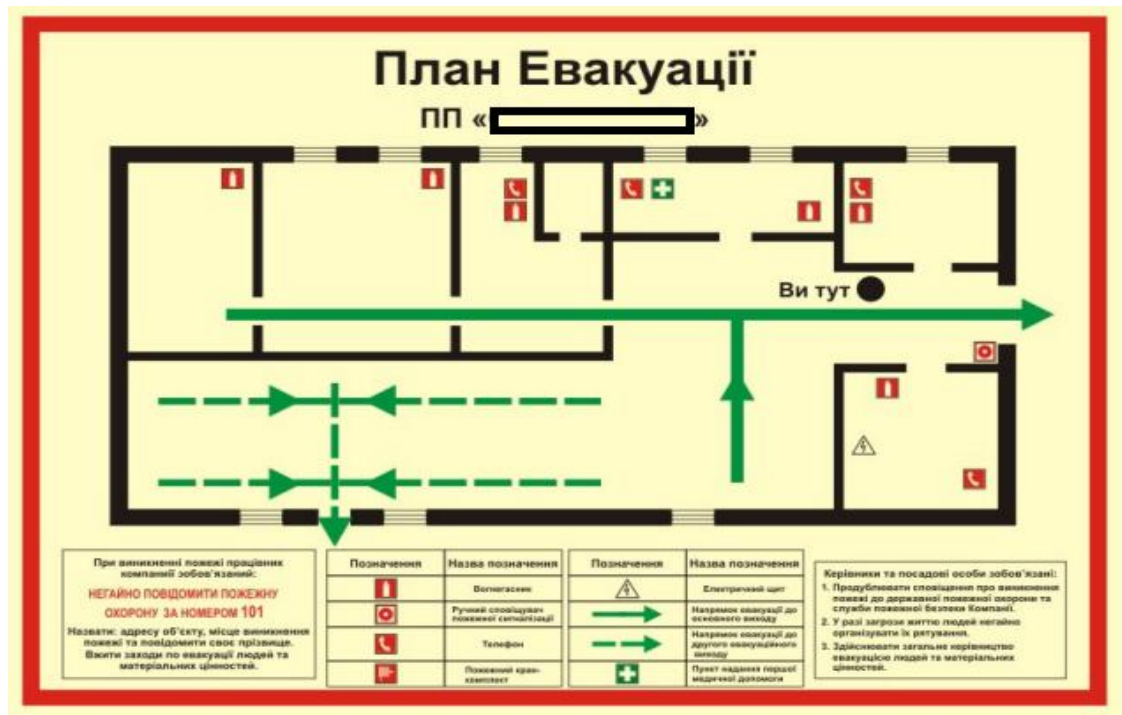
Рисунок 3.2. Приклад плану евакуації людей при пожежі
