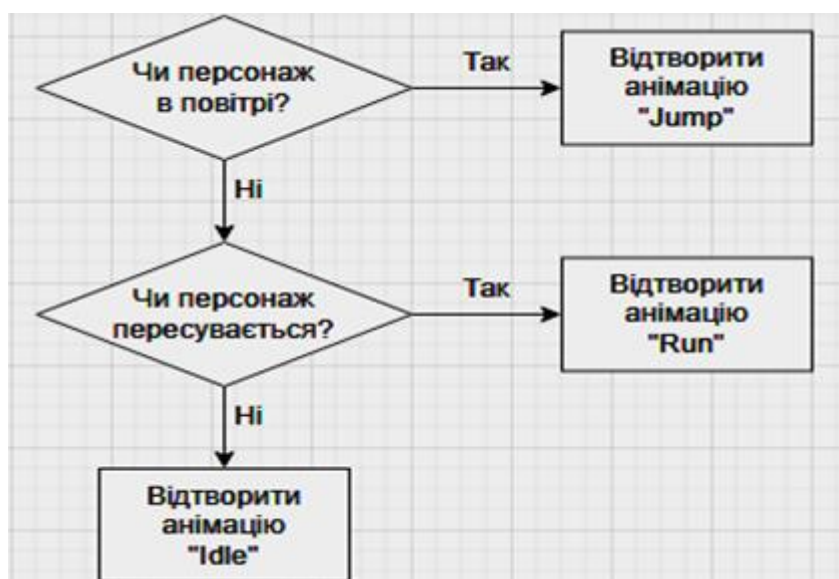
Рисунок 1.13. Алгоритм визначення анімації персонажа
