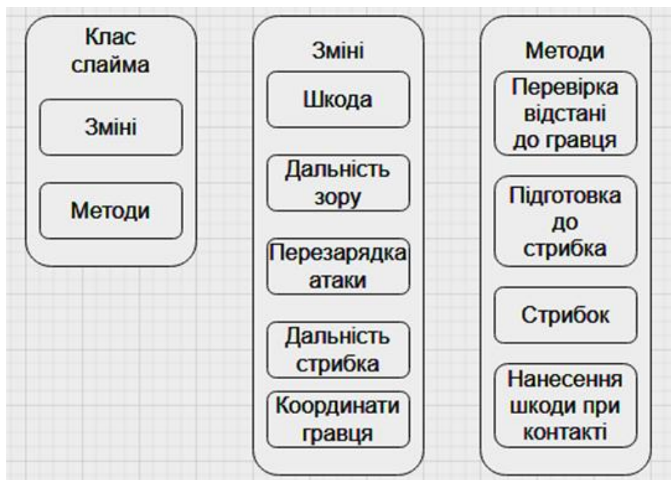
Рисунок 1.18. Структурна блок-схема класу слайма
