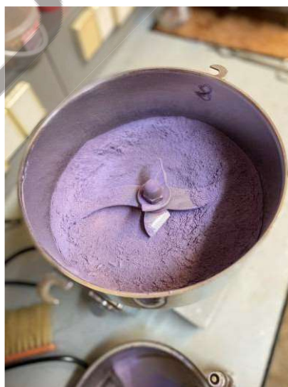
Рис.2 – Фото порошку отриманого з висушеної на конвективному сушильному устаткуванні промислового типу фіолетової капусти при технологічному режимному параметрі теплоносія t = 60^{\circ}\text{C} , v = 2,5 \text{ м/с} , d = 10 \text{ г/кг с.п.}
