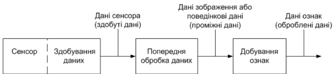
Рисунок 1.8 – Структурна схема послідовності обробки біометричних даних особистості
