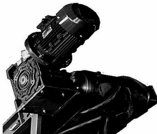
Рис. 51. Привід до стрічкового конвеєра: 1 – електродвигун; 2 – муфта пружна; 3 – черв'ячний редуктор; 4 – ланцюгова передача; I – провідний вал редуктора; II - ведений вал редуктора; III - вал приводного барабана
