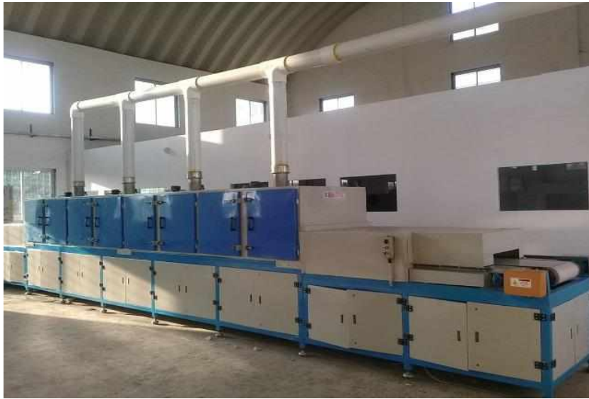
Рис. 10. Загальний вигляд (типова конструкція) МХ установки для сушіння та стерилізації сипучої сировини.
