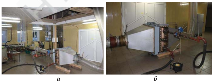
Рис. 2.1. Загальний вигляд експериментальної установки (а) та бустерний охолоджувач повітря водяний типу ОПВМ (б)
