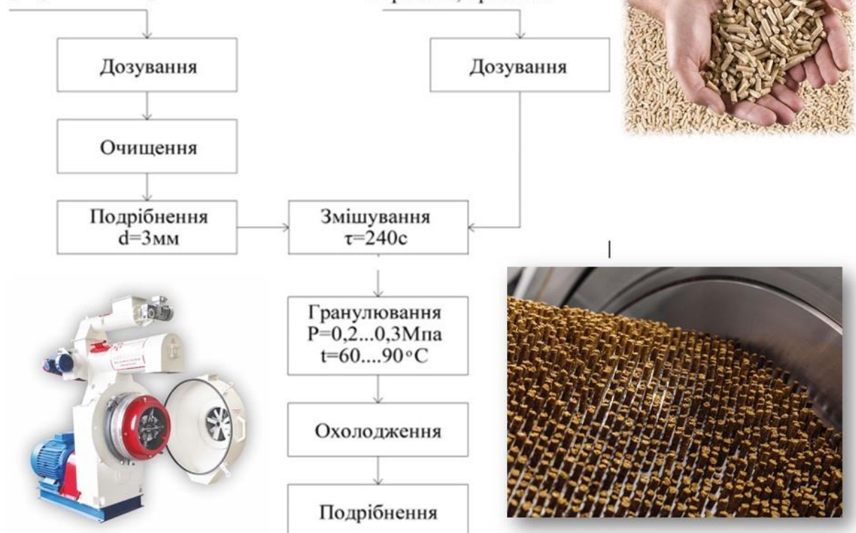
Рис. 5 – Структурна схема виробництва комбікормів для овець
