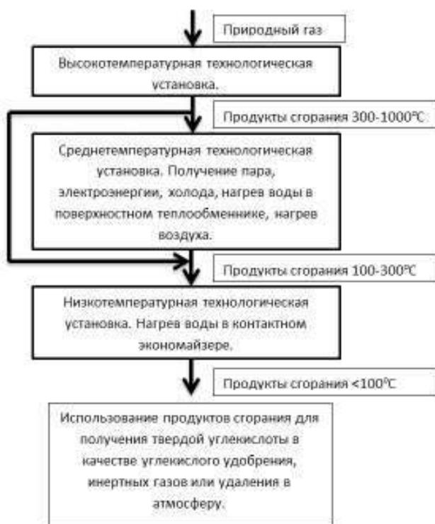
Рис. 1.10. Принципиальная схема комплексного ступенчатого использования теплоты продуктов сгорания.
