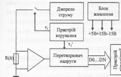
Рис.14. Функціональна схема вимірника рівня кріогенної рідини
