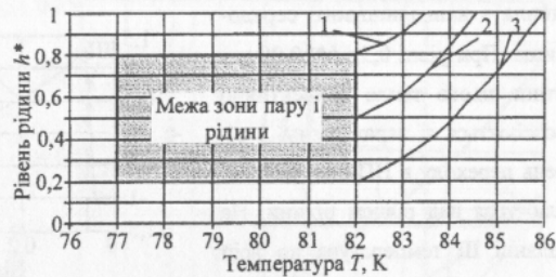
Рис.10. Значення температури на поверхні стрижня ВТНП-провідника з Bi2212, розподіленої по висоті криогенної смності при різних рівнях її заповнення, а також час, протягом якого при струмі I=3 А ця температура досягається: 1 - рівень заливки 0,8, час прогріву 6с; 2 - рівень заливки 0,5, час прогріву 4,2с; 3 - рівень заливки 0,2, час прогріву 2,2с
