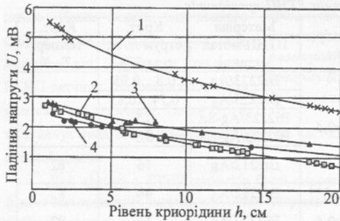
Рис.13. Зведений графік робочих досліджуваних характеристик оголених (звільнених від корундової ізоляції) ВТНП-провідників ( t_{oc}=+23...+25 °C, I=100\text{мА} ): 1 – зразок №1; 2 – зразок №2; 3 – зразок №3; 4 – зразок №4
